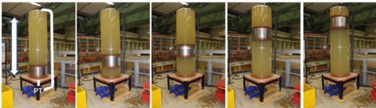
Abb. 1: Prototyp mit außenliegender Pumpturbine
